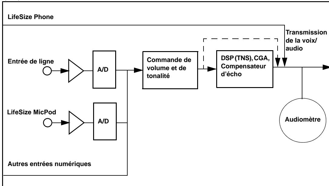
La ligne pointillée illustre le chemin audio lorsque l'option *Entrée du microphone (sans CEA)*, *Entrée de ligne 1 (sans CEA)* ou *Entrée de ligne 2 (sans CEA)* est sélectionnée comme microphone actif. Ce mode est utile pour paramétriser des gains du système mais ne doit jamais être utilisé pendant les appels à moins que l'installation ne comprenne des entrées audio avec CEA externe. Un écho peut se produire lorsqu'aucun CEA n'est utilisé.
