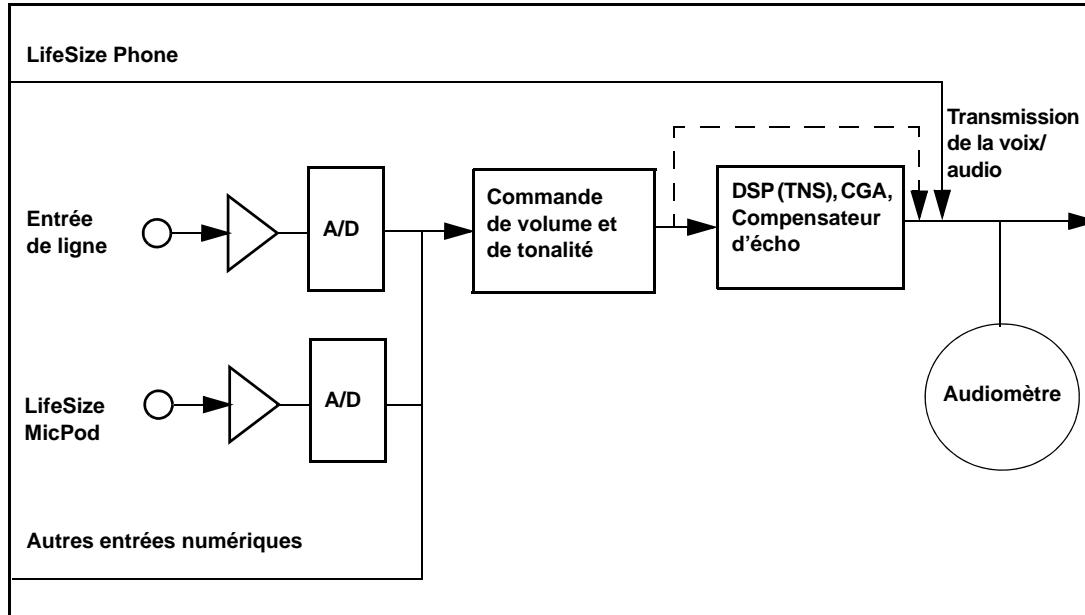
La ligne pointillée illustre le chemin audio lorsque l'option *Entrée du microphone (sans CEA)*, *Entrée de ligne 1 (sans CEA)* ou *Entrée de ligne (sans CEA)* est sélectionnée comme microphone actif. Ce mode est utile pour paramétriser des gains du système mais ne doit jamais être utilisé pendant les appels à moins que l'installation ne comprenne des entrées audio avec CEA externe. Un écho peut se produire lorsqu'aucun CEA n'est utilisé.
