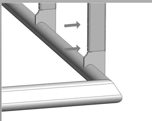
**2 -** Visser jusqu'au blocage les 2 vis d'extrémité noyées dans le longeron (BTR 3)
