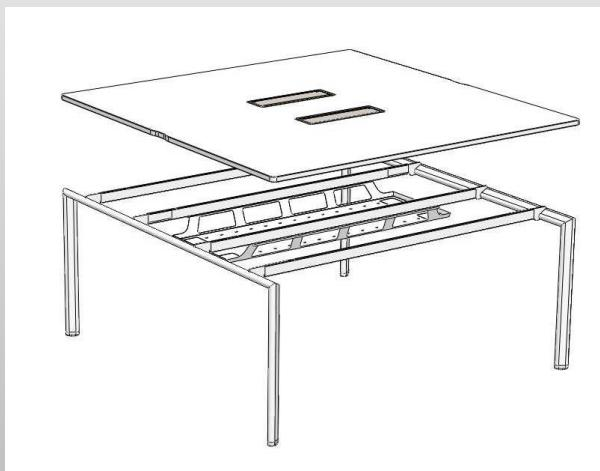
**4 -** Positionner le plan sur la structure.
